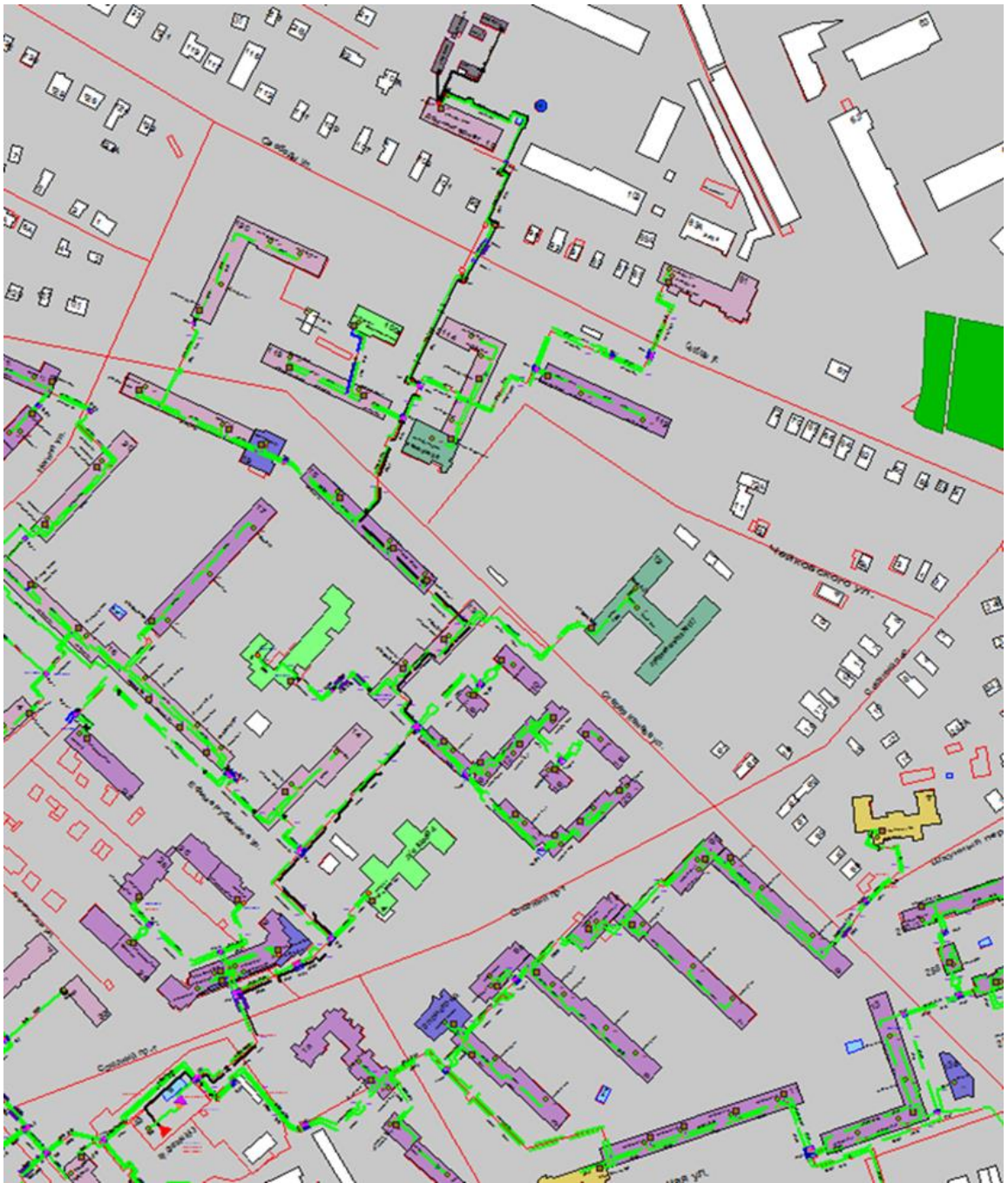
Рисунок 3.62 – Трассировка теплопровода от котельной АО «Теплоэнерго» по пр. Союзный, д. 43 до конечного потребителя «ПТ-Радищ,18»
