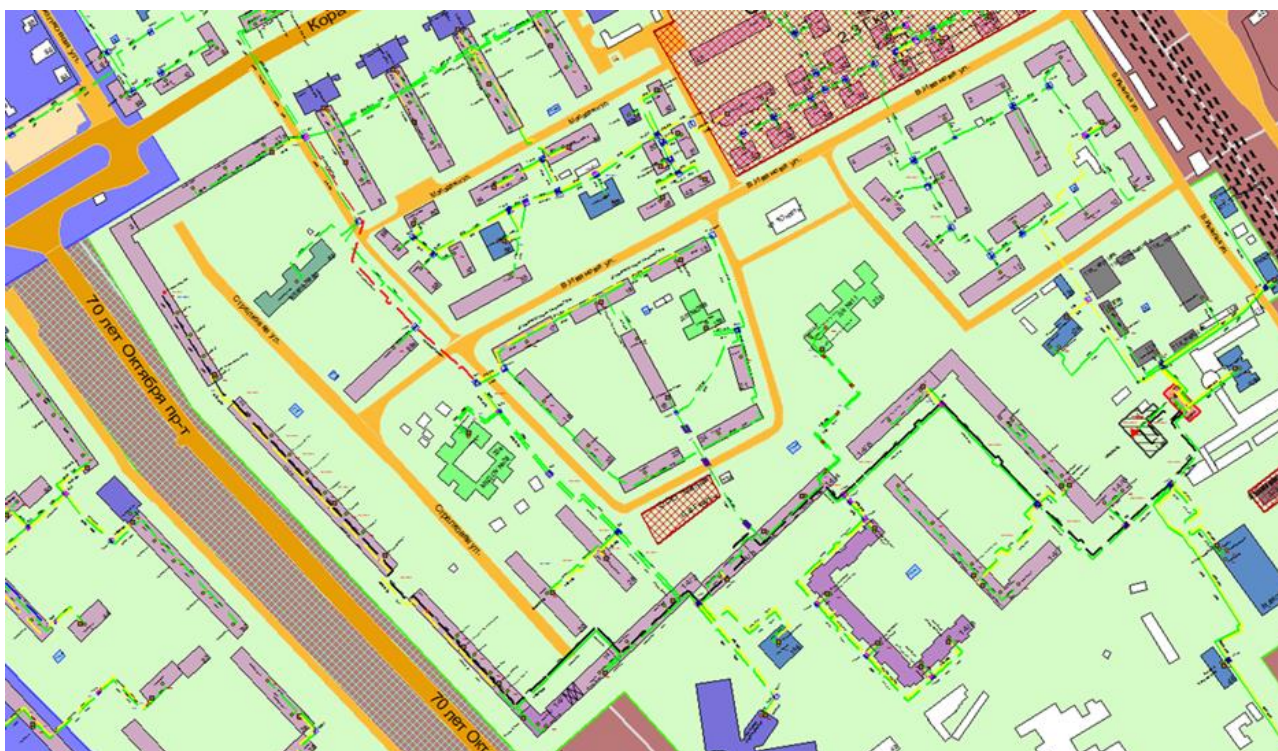
Рисунок 3.66 – Трассировка теплопровода от котельной АО «Теплоэнерго» «3 МР Сормово» по ул. Иванова, д. 14Д до конечного потребителя «ПТ-Телег,3 55»
